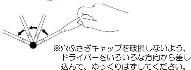
※穴ふさぎキャップを破損しないよう、ドライバーをいろいろな方向から差し込んで、ゆっくりはずしてください。
