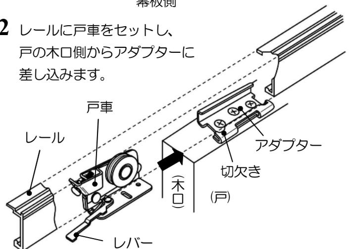
\*レバーがアダプターの切欠き部に確実に入るように、カチッと音がするまで完全に押し込んでください。
