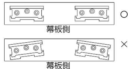
2 レールに戸車をセットし、戸の木口側からアダプターに差し込みます。
